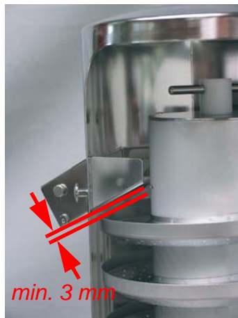
Fig. 7 Zwischenraum Wendel – Auslauf
