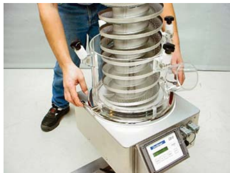
Fig. 42 Exzenterklemmhebel lösen
