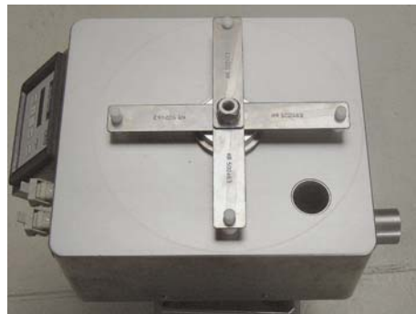
Fig. 67 Zentrierung der Ankerkupplung mit Lehren
