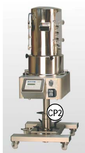
Fig. 16 Entstauber E2000S auf Stativ STW500
